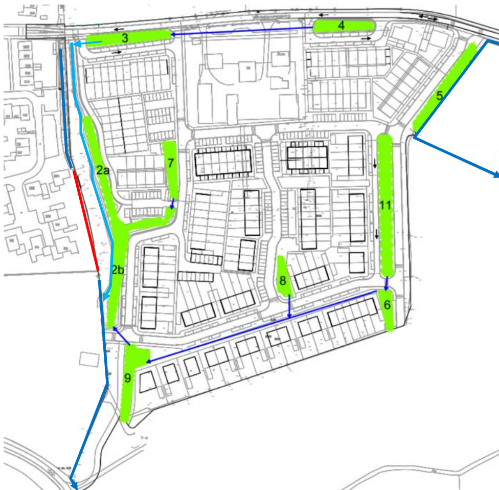
Afbeelding 9 Afwateringstructuur bovengrondse afvoer naar wadi's
